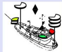
Remolcador mayor de 50 metros, con remolque mayor de 200 metros.
